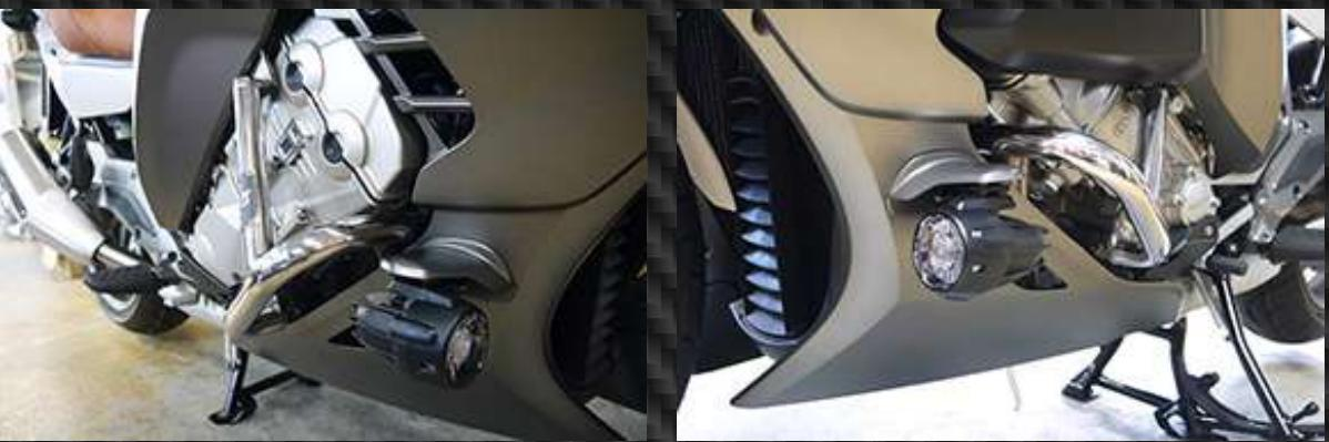
ご存じ 2022 年式の GT/GTL には、純正のエンジンガードがあります。しかしこれはエンジン上下のみボルトオンの **2 点留め** であり、**大転倒**時には曲がってしまい、また、アルミ製エンジンのボルト穴をも破損する可能性が有ります。
